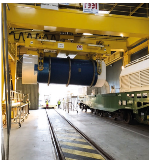
Emballage Castor HAW28 en cours de chargement.
