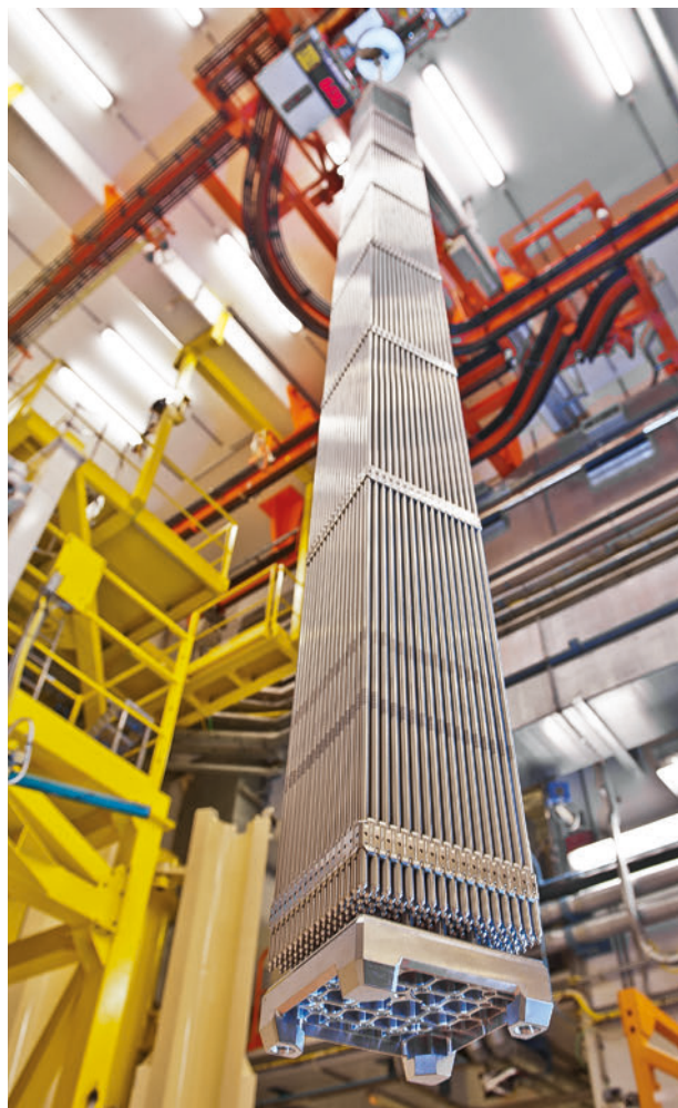
Assemblage de combustible.
