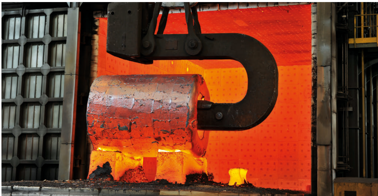
| Fabrication d'une virole.
